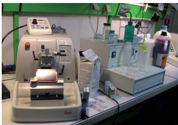
Fig. 1. Matériel : microtome, lames, paraffine, plaque réfrigérante et blocs, colorants, solvants
